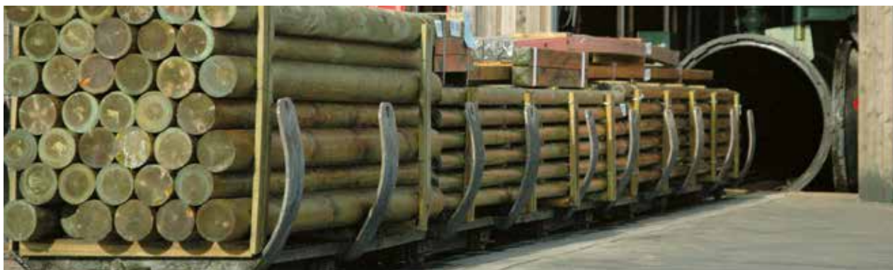
Loren mit Gartenholz – Beladen der Kesseldruckanlage
