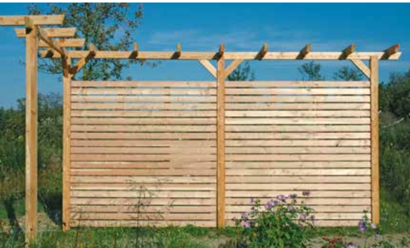
Pergola Standard und Verlängerung aus naturbelassener Lärche mit geraden Reitern, Kopfbändern und Rhombuszaun, vom Kunden selbst gestaltet
