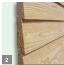
Fassadenprofil 29/15 x 141 mm, mit Nut und Feder, glatt gehobelt, technisch getrocknet
