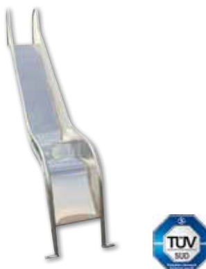
10 Metallrutsche Edelstahl Rutschfläche aus poliertem Edelstahl, die günstige Alternative zu Volledelstahl-Rutschen, Seitenwangen und Rohre verzinkt, Podesthöhe 150 cm, Länge 290 cm, Breite außen 46 cm, innen 40 cm, Höhe der Ohren ca. 60 cm, vandalismussicher, kratzfest.
